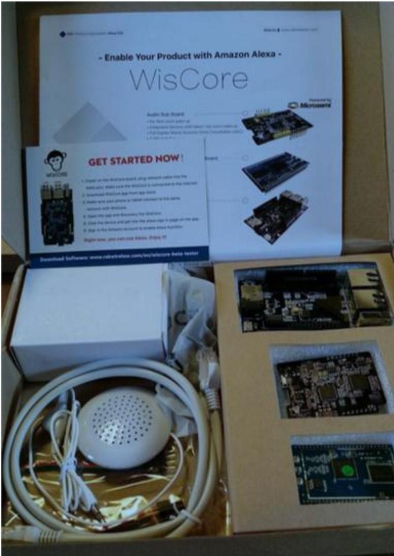
WisCore 盒内有 Arduino 兼容接脚的开发主板，一块运算符板，一块音效子板。主板的 Arduino 接脚内还安排了两层子板扩充脚位，所以插上两块子板之后，仍然可以再插上 Arduino 模块没问题。
