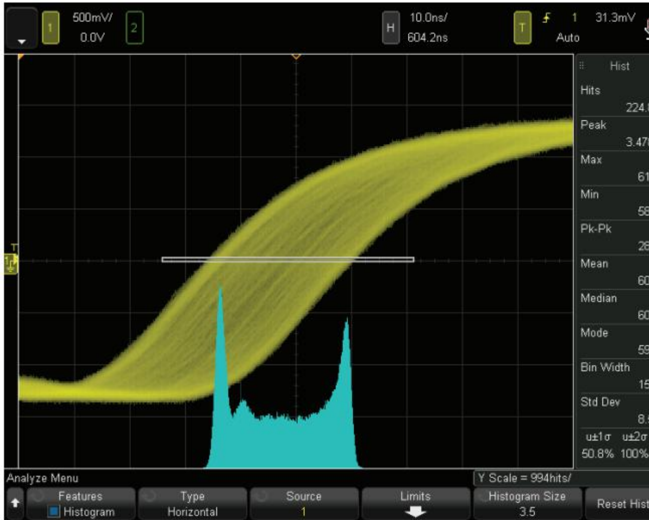
图 2 基本抖动分析；通过波形直方图查看重复时钟抖动。直方图（蓝色）显示时钟抖动（黄色）呈双峰分布
