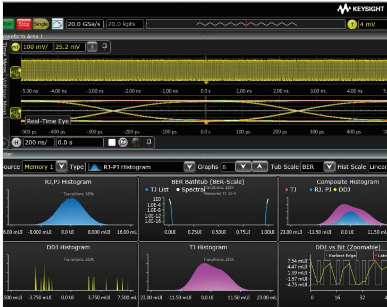
图 3 使用配备 EZJIT+ 选件的 Infiniium S 系列 10 位示波器执行抖动分离和推算总体抖动
