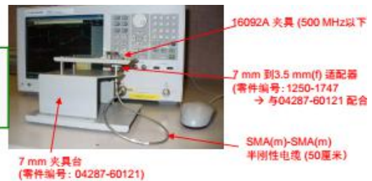
Figure6 用增益—相位测量端口, 采用串联一直通法测量阻抗
