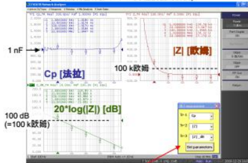
Figure6 用增益—相位测量端口, 采用串联一直通法测量阻抗
