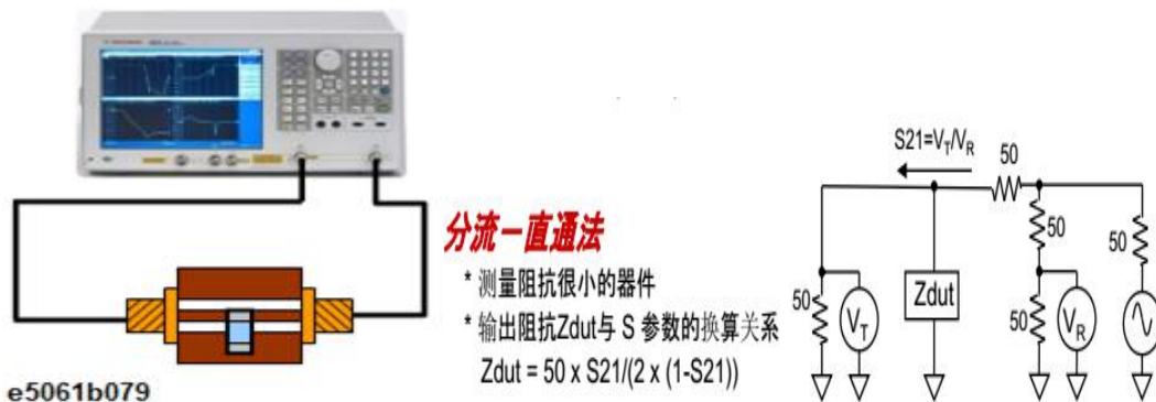
Figure2 用双端口方法测试 PDN 输出阻抗
