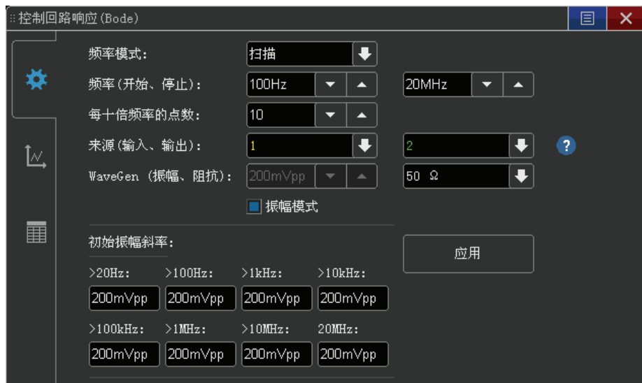
图 7: 利用幅度配置优化信噪比
