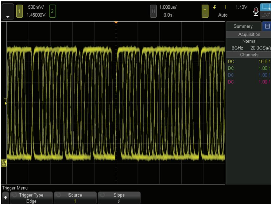
图 2：在数据信号上触发时，重复捕获连续的串行总线数据信号。
