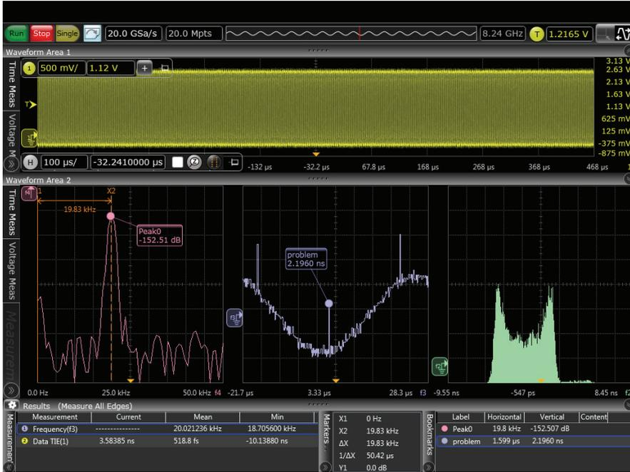
图 8：使用运行 EZJIT 选件的 Keysight Infiniium 系列示波器执行抖动分析。
