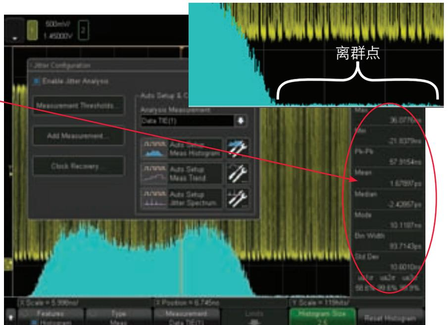
图 3：使用 TIE 直方图进行的抖动分析。
