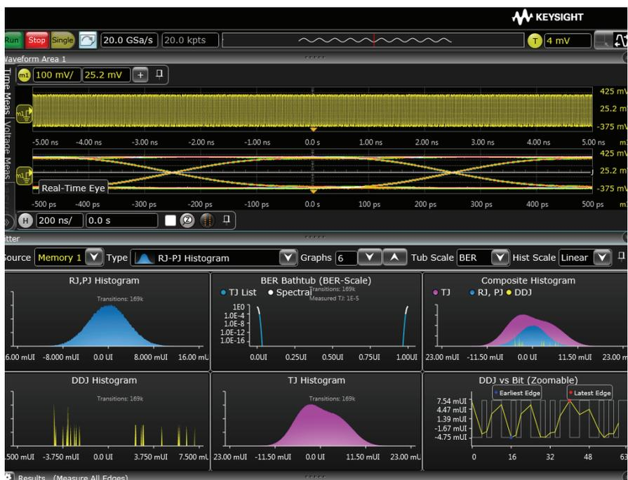
图 10：使用配备 EZJIT+ 选件的 Infiniium 系列示波器执行抖动分离和推算总体抖动。
