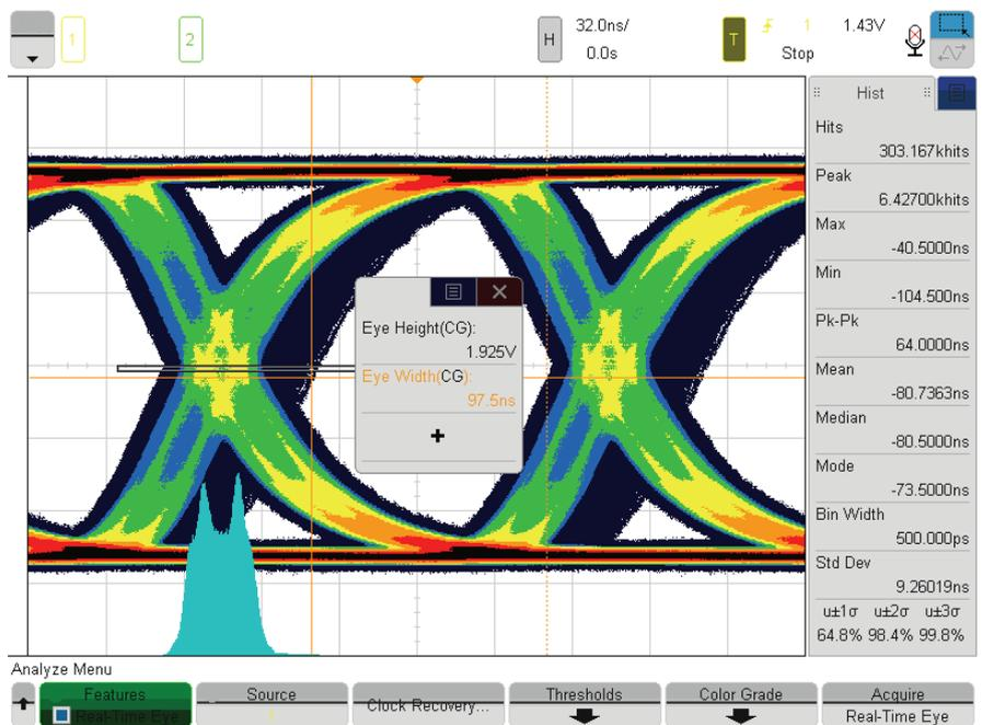
图 7: 该眼图给出了边沿抖动和噪声的峰峰值信息, 图中黑色迹线表明波形边沿抖动的极端情况, 对应直方图显示的“离群现象”, 在眼图上则表现为最差情况下的眼开。
