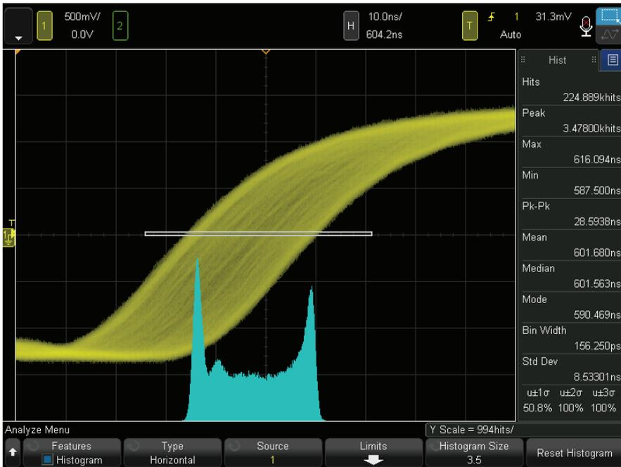
图 1：基本抖动分析；通过波形直方图查看重复时钟抖动。直方图 (蓝色) 显示时钟抖动 (黄色) 呈双峰分布。
