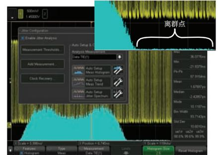
图 3: 使用 TIE 直方图进行的抖动分析。
