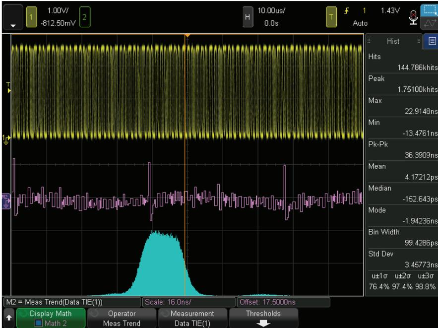
图 6: 与图 4 相比, 使用一阶 PLL 时钟恢复算法进行的抖动测量使抖动直方图的双峰分布特征减弱, 高斯分布特征增强。
