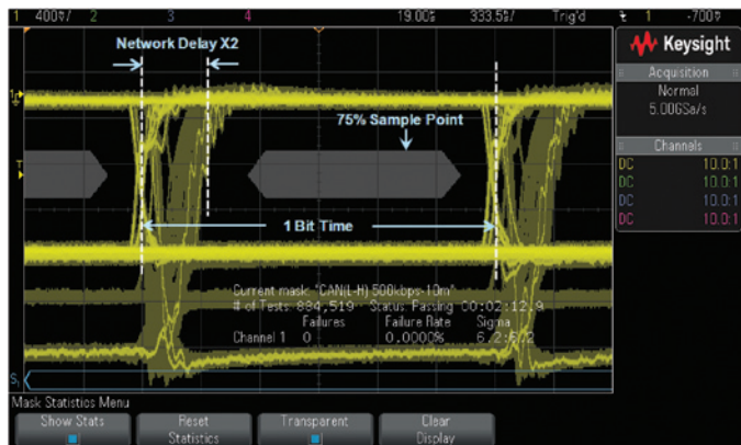
图 4: CAN 眼图模板测试显示了所有的帧和比特的幅度变化和时序不确定性, 包括网络传播时延。
