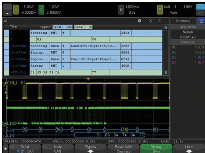
图 6: 双总线时间交叉列表显示可以更轻松地通过 CAN-LIN 网关跟踪数据。
