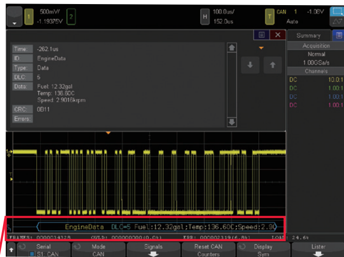
图 7: 实时帧计数器和总线利用率测量可以表征 CAN 和 FlexRay 系统。
