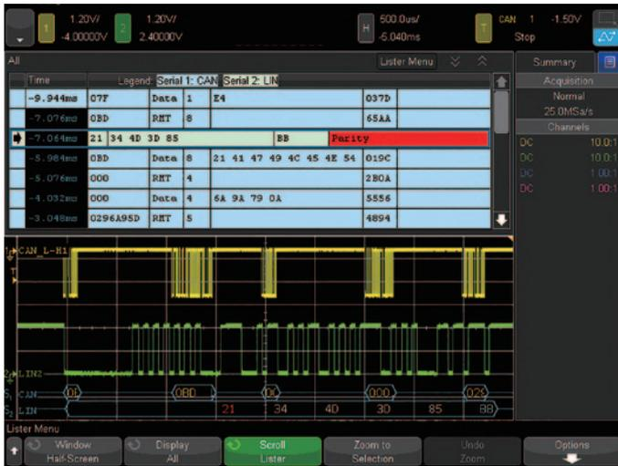
图 4: 交叉“列表”可以清晰显示 2 个解码串行总线活动之间的时间关联。
