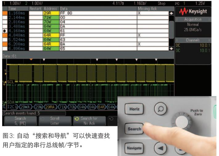
图 3: 自动“搜索和导航”可以快速查找用户指定的串行总线帧/字节。
